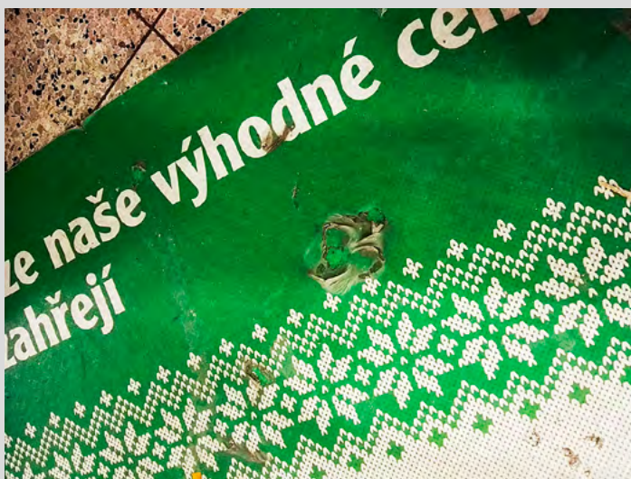
První fáze poškození podlahové grafiky. Kolečko paletového vozíku narušilo laminaci, která se později zcela odtrhne včetně lepidla a inkoustu a na grafice vzniknou bílé skvrny.
