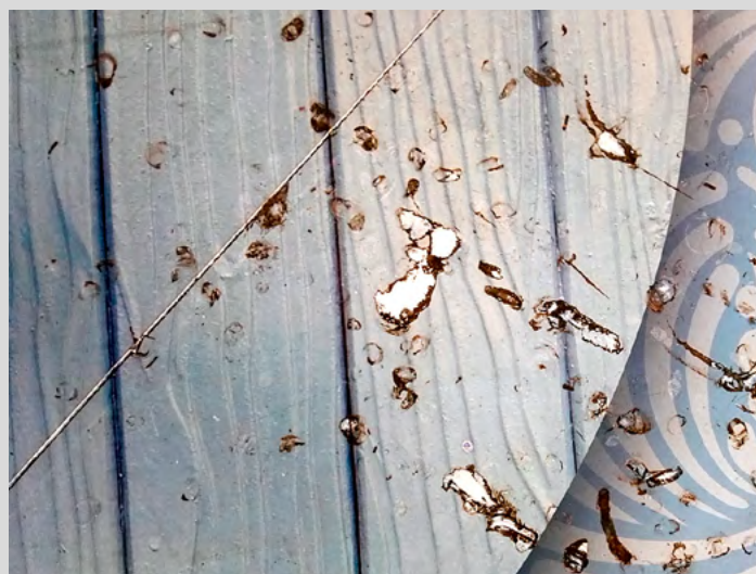
Ukázky poškození podlahové grafiky od různých typů koleček. Někde je laminace pouze narušená, jinde už se odtrhla a odhalila tiskovou fólii zbarvenou inkoustu. Na zbytky lepidla se chytá prach a špína a degraduje celou aplikaci.
