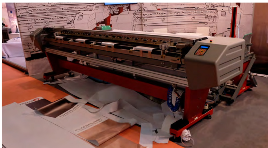
Linka pro formátování tapet tištěných na médium s šířkou 3,2 metru je sestavena z odvíječe JRU 320 a řezačky XLD 320 HS
