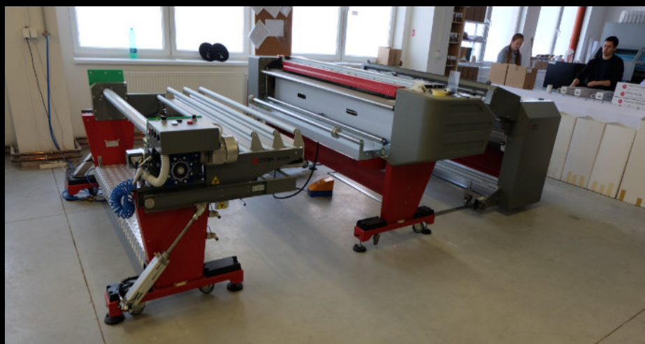
Na automatické formátování tapet v tiskárně Durst Rho 512R slouží tato linka sestavená z odvíječe jumbo rolí, řezačky a rolovačky Fotoba
